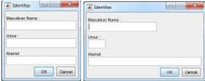
Gambar 4.16 Input Dialog Box dengan beberapa Input Edit Text dengan ukuran yang berbeda
